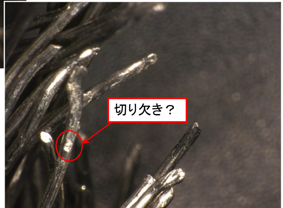
図3 ワイヤーA破断部拡大像(マイクروسコープにて観察)
